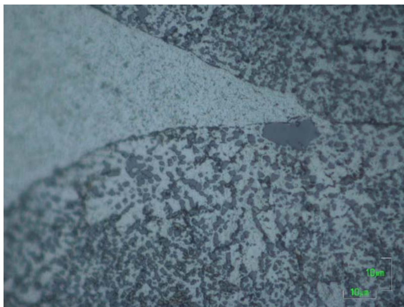
Рис. 6 Микроструктура брикета (70%1379+30%АД0) после РКУ прессования, t=500^{\circ}\text{C} , 1 проход, увел. 1000
