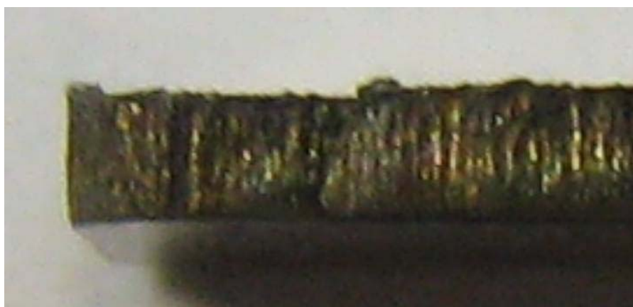
Рис. 7. Внешний вид реза (заметна бороздчатая структура реза).
