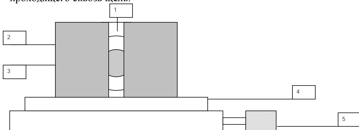
Рис. 2.1. Схема эксперимента. 1 - Движущаяся щель, 2 - Приемная площадка измерителя, 3 - Поперечное сечение пучка, 4 - Предметный столик, 5 – Микрометр.
