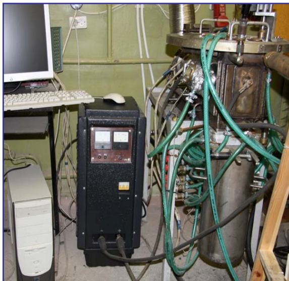
Рис. 1. Внешний вид опытной установки для производства фуллерен-содержащей сажи и катодного депозита
