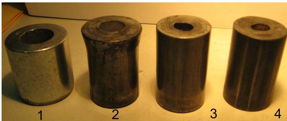
Рис.5 Результаты экспериментальной штамповки. Слева направо: 1-начальная заготовка, покрытая цинк-фосфатным слоем, 2-полуфабрикат в стадии обжима, 3,4-полученные детали
