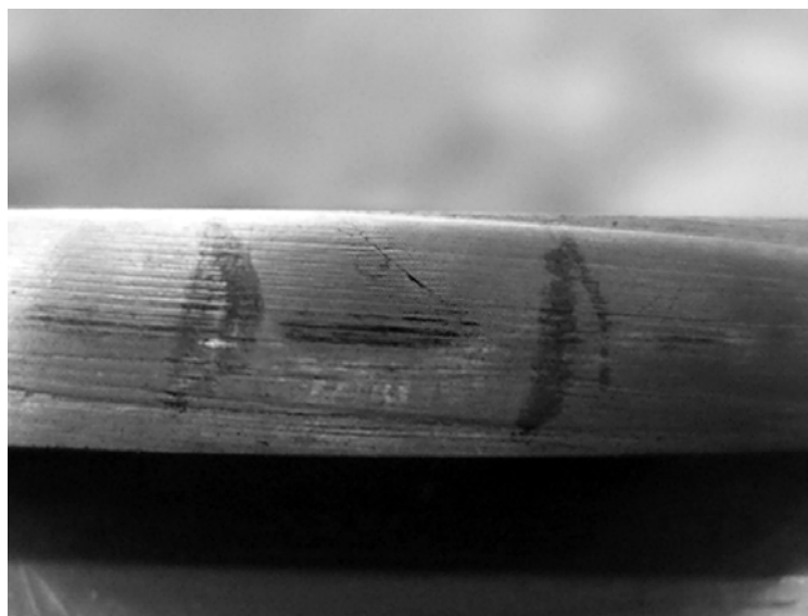
Рис.2 Место разрушения осажённого образца
