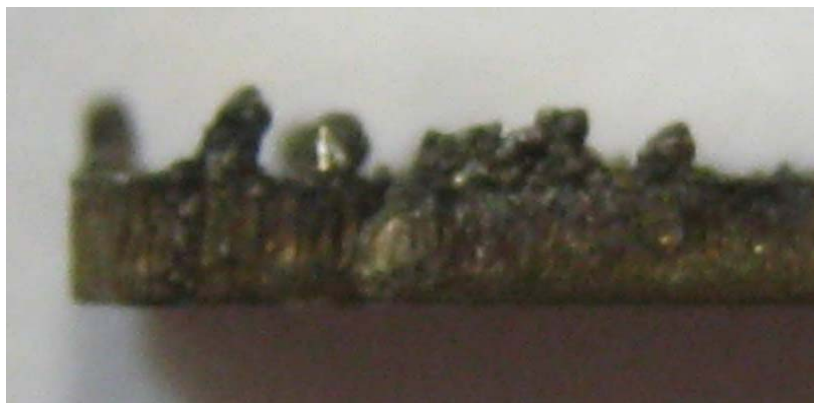
Рис. 8. Большой грат. Образец №18.
