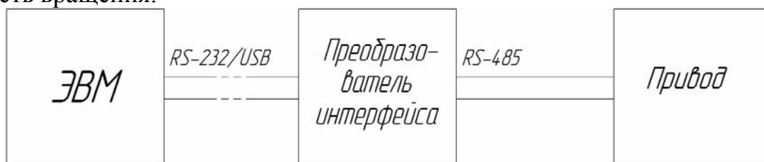
Рис.1. Схема подключения привода к ЭВМ
