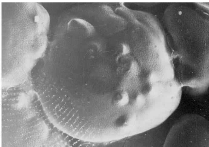
Рис.3 Закристаллизованная жидкая фаза на грануле сплава ЭП741НП (x 500мкм)
