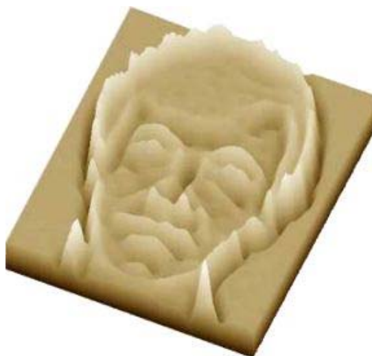
Рис. 7. Пример изображения, сформированного методом наночеканки
