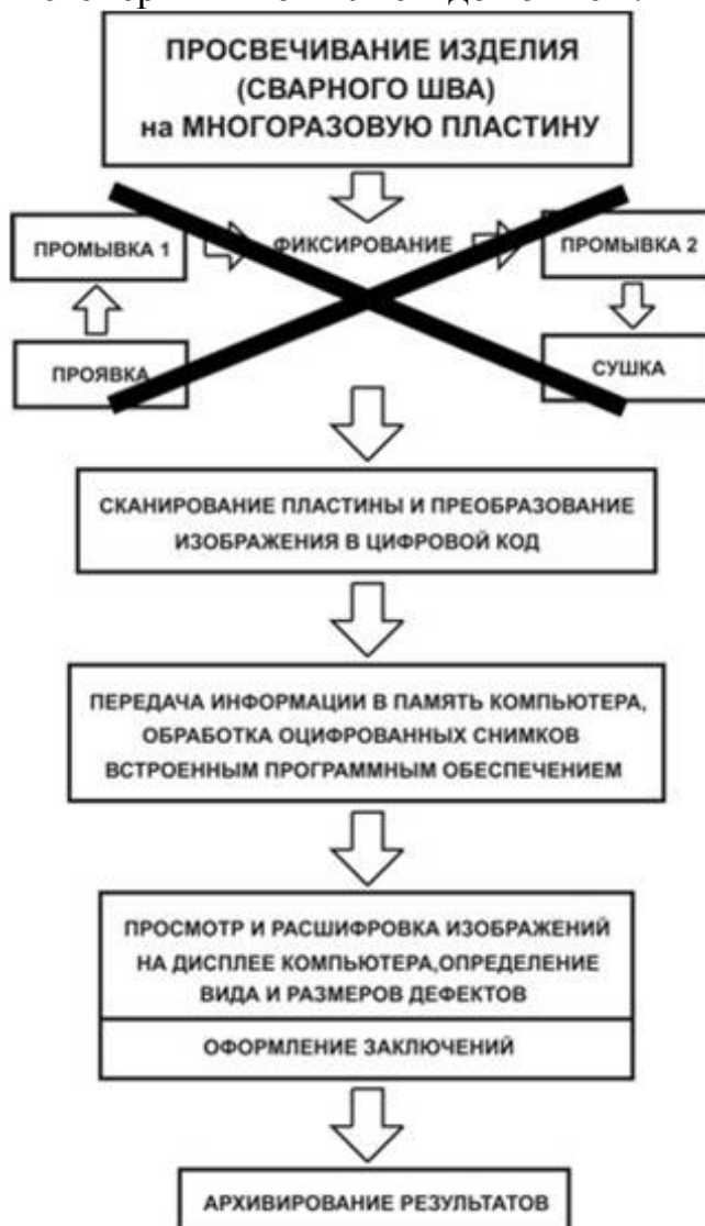
Рис. 1. Схема контроля с использованием фосфорных пластин
