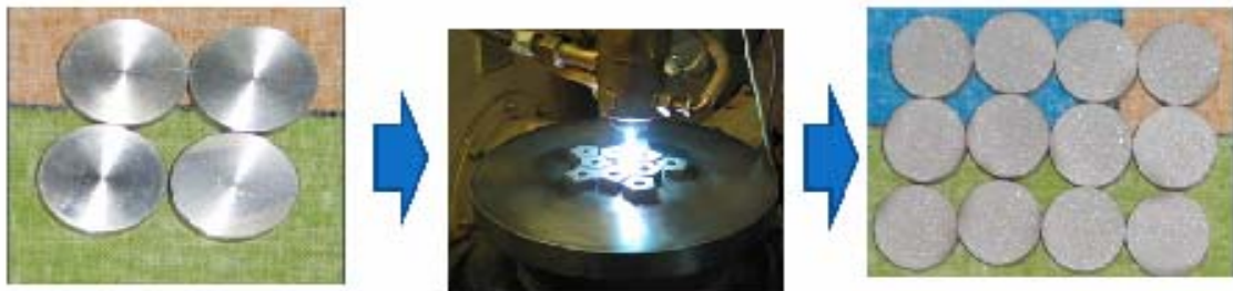
Исходные образцы(Сталь 3 и Д16) – диаметр 20мм, h16мм.
