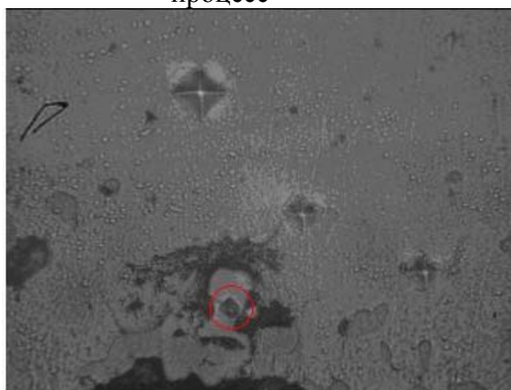
Рис. 3.17. Измерения микротвердости карбидов
