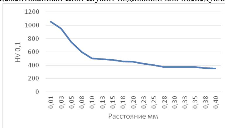
Рис. 2. Распределение твердости азотированного слоя по глубине
