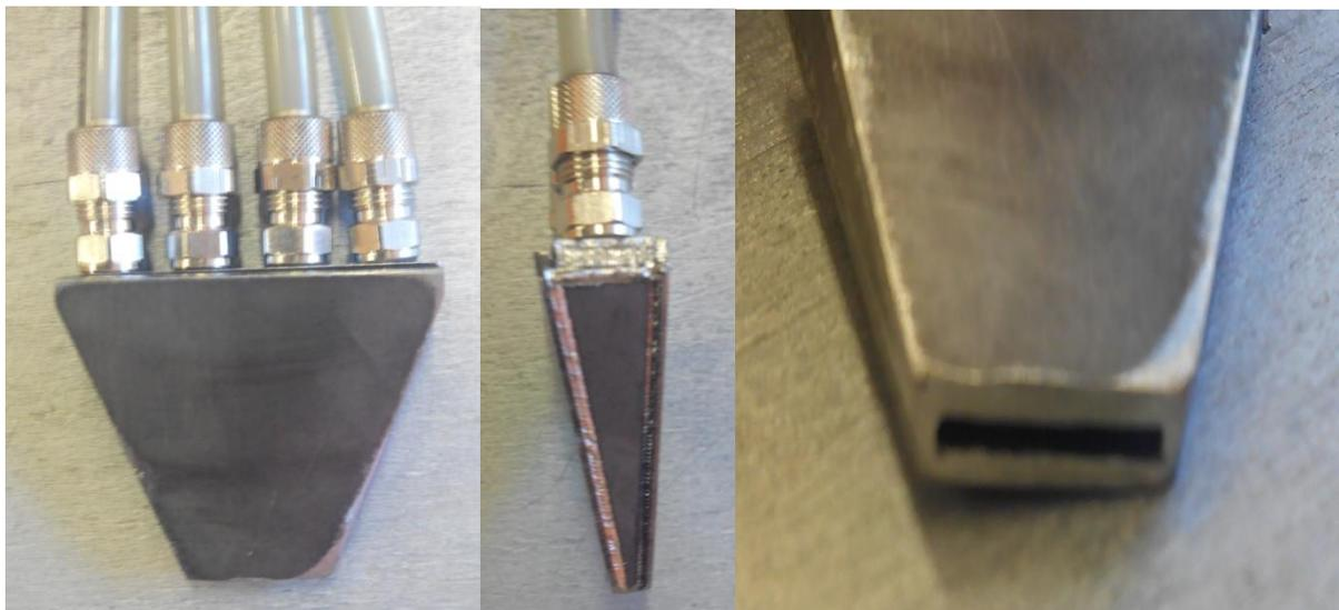
Рис. 3. Фотографии опытного образца порошкового сопла
