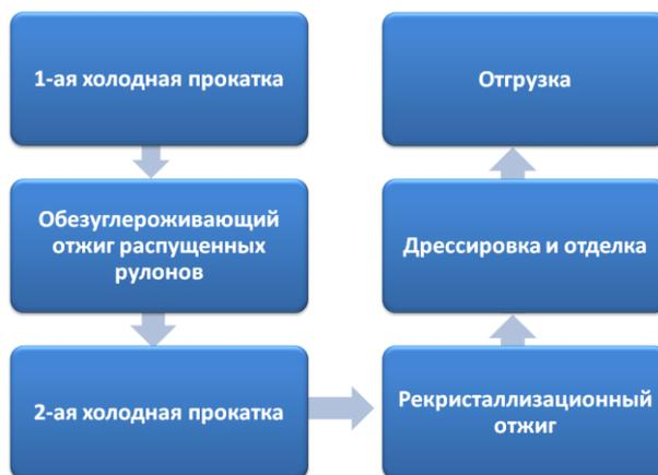
Рис. 1. Разработанная технология производства полос для магнитных экранов
