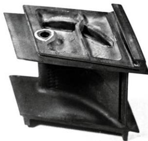
Рис. 1. Внешний вид сопловой лопатки с изношенным отверстием под штифт
