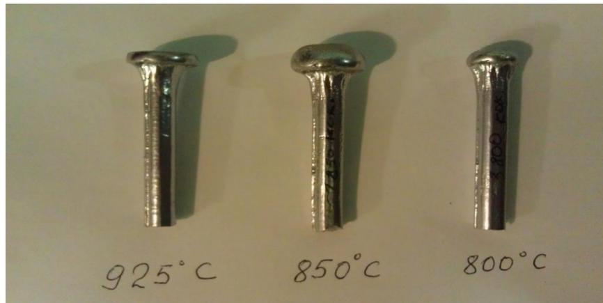
Рис. 2. Концы проб на жидкотекучесть при разных температурах
