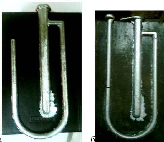
Рис.1. Отливки, полученные литьем в комплексную пробу с вертикальным U-образным каналом: а) сплав Al-9%Si, б) сплав Al-3.5%Ca-3%Mg-10%Zn.
