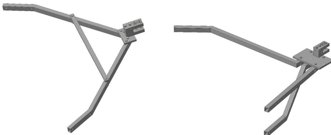
Рис. 2. Модели кронштейнов на двух и трех опорных балках
