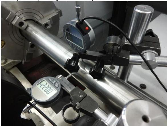
Рис. 1. Фото установки для проверки токарного станка 16К20ФЗ на точность.
