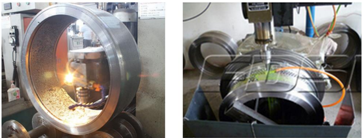
Рис.2. Сверление отверстий в цилиндрической матрице: а - на многооперационном станке с ЧПУ; б - на вертикально-сверлильном станке с ЧПУ
