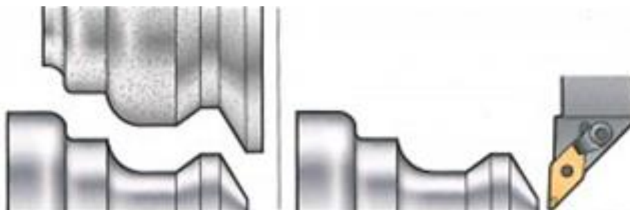
Рис. 2. Изготовление детали методами шлифования и «твердого точения»
