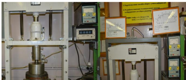
Рисунок 3 – Исследование деформации втулки и тарировка датчика силы на гидравлическом прессе.
