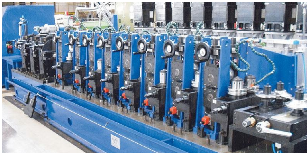
Рис. 2. Кластерные клетки на трубоформовочном стане
