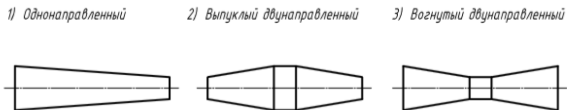
Рис. 2. Основные формы листов с переменной толщиной по длине.
