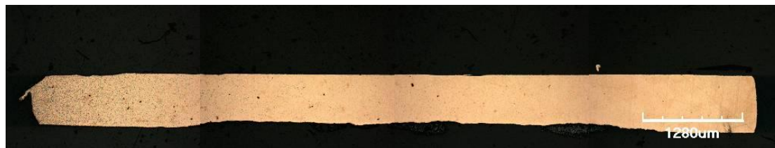
Рис. 1. Фронт окисления меди в контакте с \text{TeO}_2 при 650 °С
