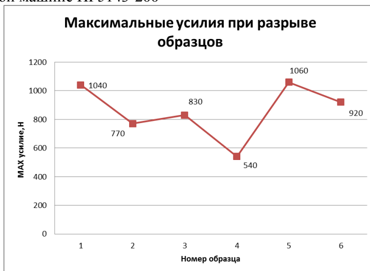
Рис.4. График зависимости максимального усилия при разрыве образцов.
