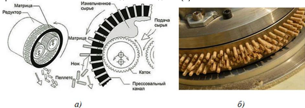
Рис.1. Работа гранулятора с цилиндрическими матрицами: а - принцип действия гранулятора; б - процесс формирования топливных пеллет
