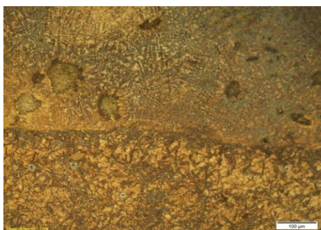
Рис.2. Микроструктура наплавленного слоя порошком НХЧ-31
