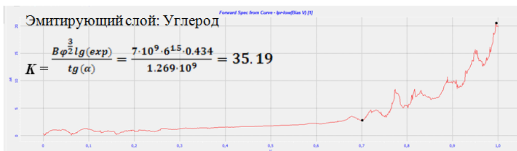
Рис. 3. Вольтамперная характеристика промежутка зонд-образец для структуры золото-опал-золото-УНС.
