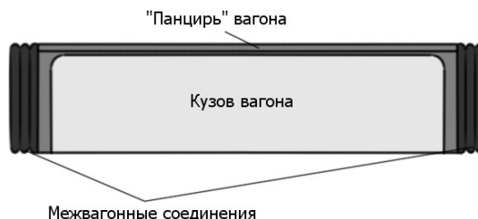
Рис.4. Конструкция промежуточного вагона
