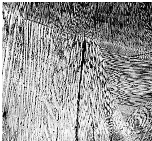
Рис. 1. Характер расположения трещин в зоне оплавления отдельных валиков (св. проволока типа Х15Н23М4В4)
