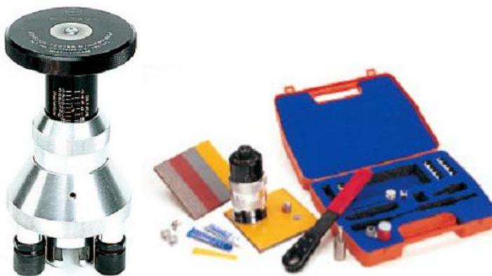
Рисунок 5 – Внешний вид прибора, использовавшегося для измерения адгезии
