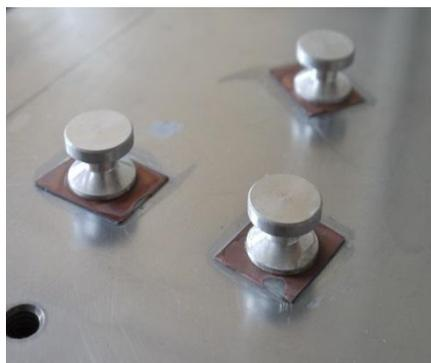
Рисунок 6 – Образцы металлизированных подложек перед проведением измерения величины адгезии
