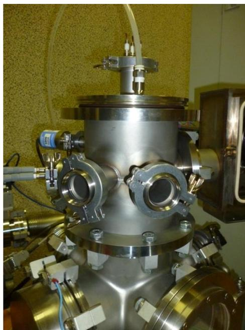
Рисунок 3 - Внешний вид стенда для проведения испытаний опытного образца источника пароструйного осаждения
