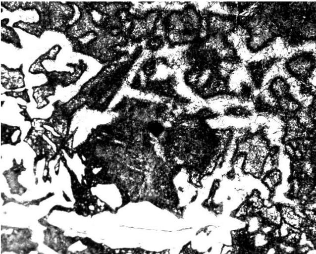
Рис. 5 Микроструктура упрочненного слоя Стали 35 (x100)
