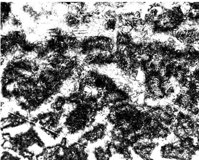
Рис. 6 Микроструктура упрочненного слоя Стали 35 (x100)
