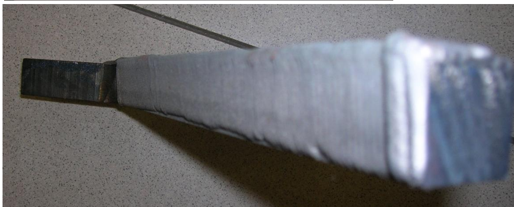
Рис. 4. Работоспособный нож после нанесения покрытия, а) – вид сверху, б) – вид сбоку
