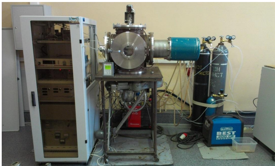
Рис. 2. Вакуумный универсальный пост (ВУП)
