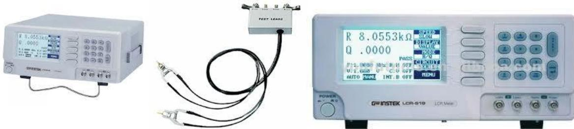
Рис. 8. Измеритель импеданса LCR-821 фирмы Instek
