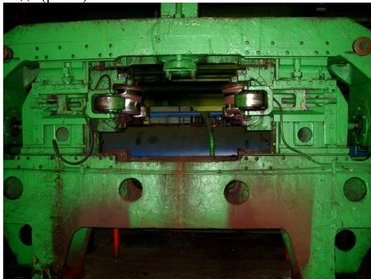
*Рис. 4. Кромкогибочная клетка конструкции ЭЗТМ*
