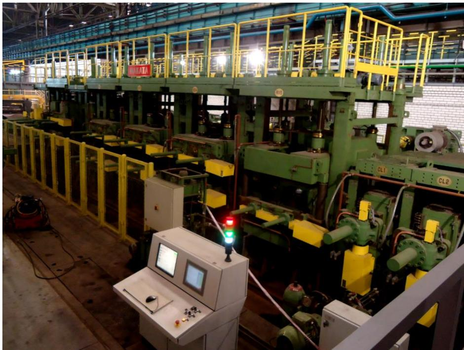
Рис. 9. Формовочный стан FFX фирмы NAKATA
