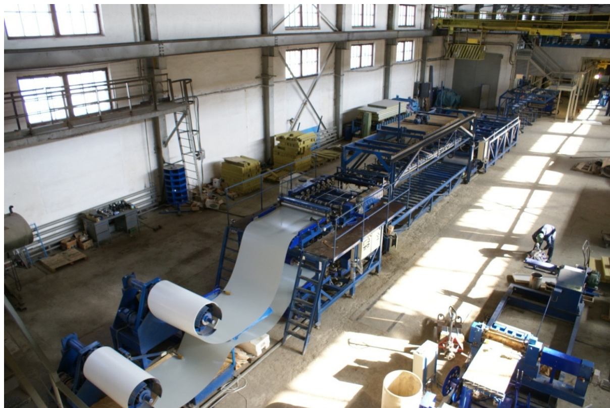
Рис. 3 Общий вид линии по производству сэндвич – панелей
