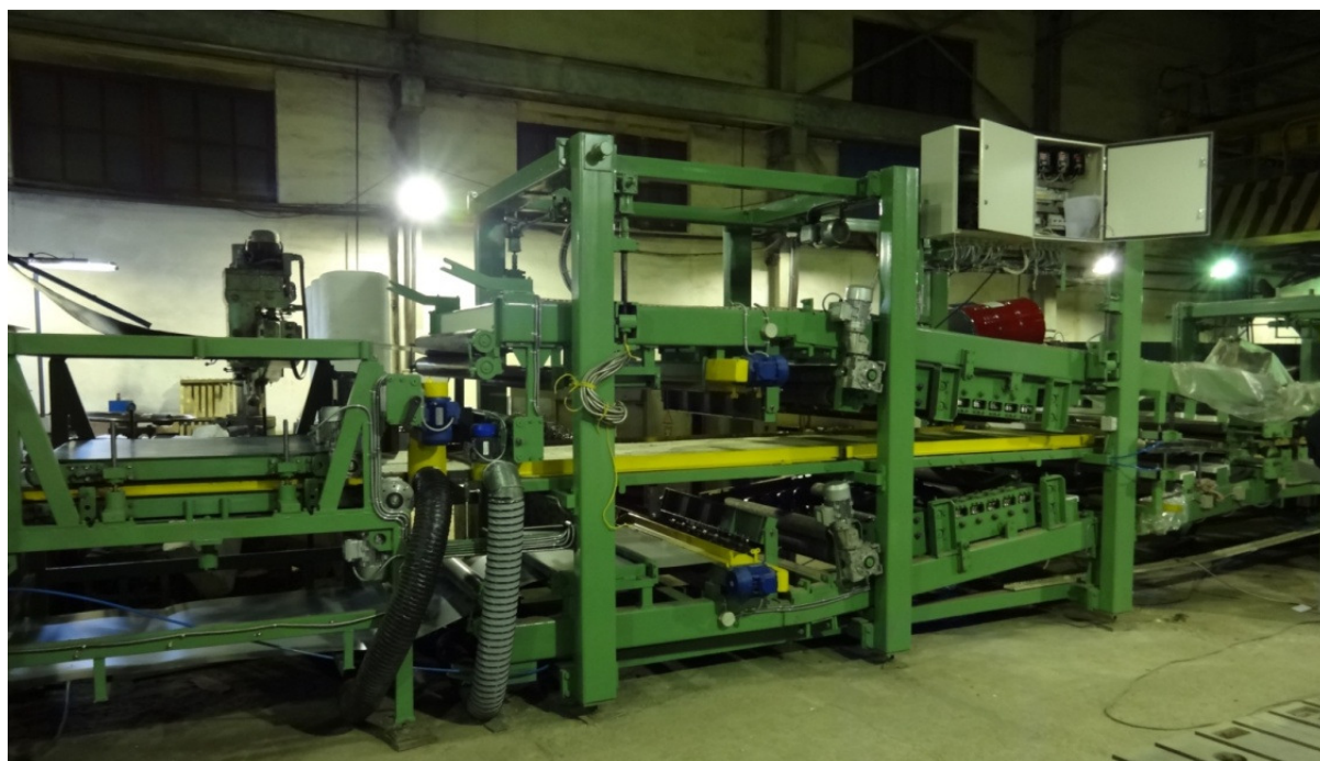
Рис.5 Непрерывная линия для производства сэндвич – панелей
