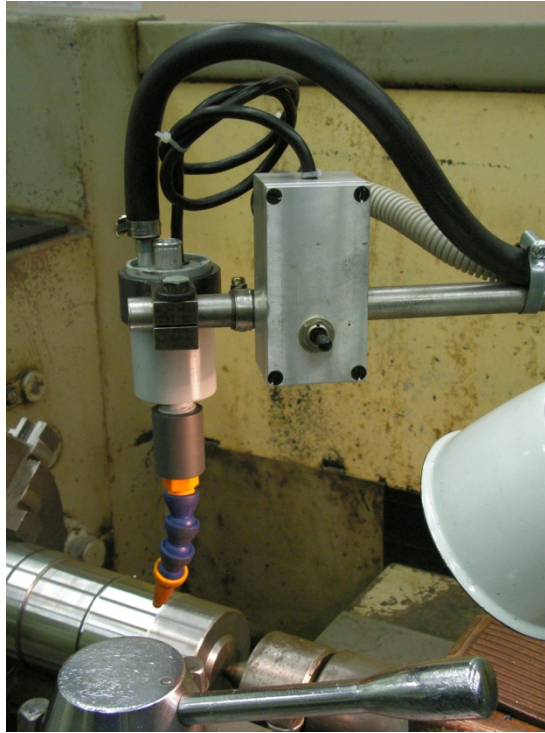
Фото 2. УОИВ с дистанционным пультом управления, установленные на станке
