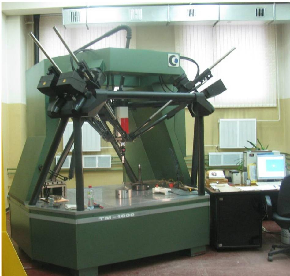
Рис.1. Шестиосевая координатно-измерительная машина
