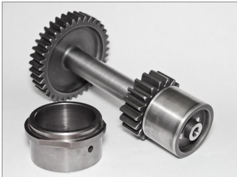
Рис. 1. Блок шестерён с керамическим подшипником скольжения
