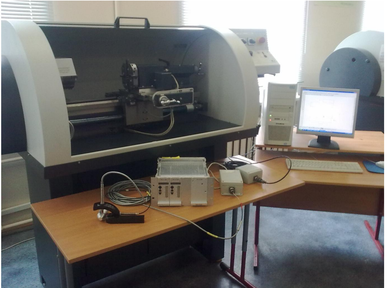
Рис. 10. Токарный станок мод.СС-D-6000Е с ЧПУ KOS2 и приспособление для измерения относительных виброперемещений резца и обрабатываемой детали
