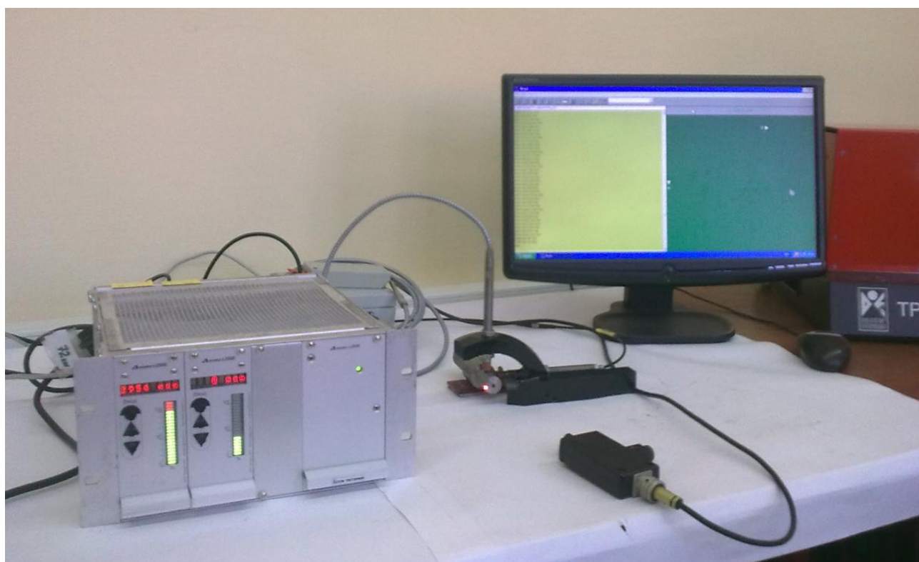
Рис. 9. Статическая тарировка бесконтактных вихретоковых датчиков мод. СИЭЛ-166Д-10-20 и СИЭЛ-166Д-10-125
