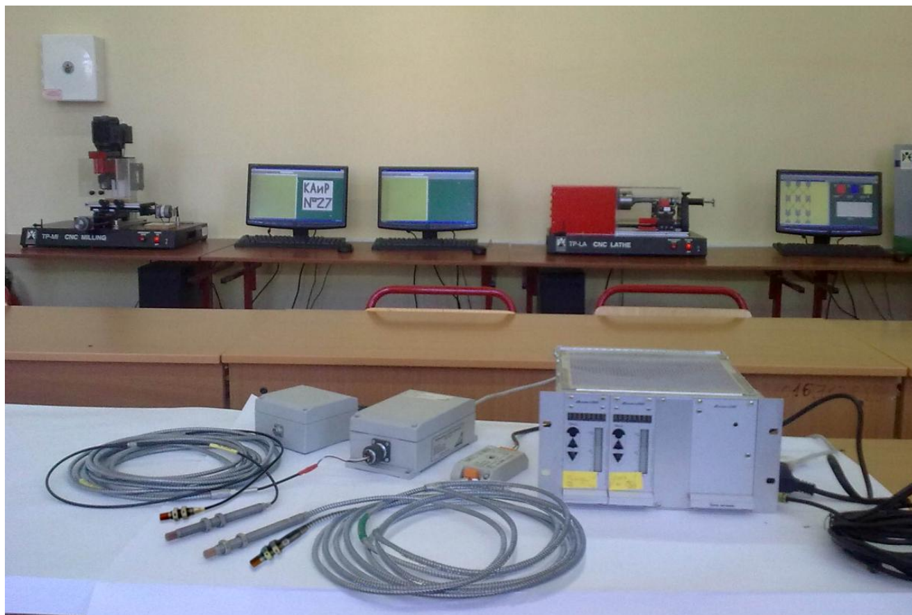
Рис. 8. Виброизмерительная аппаратура с бесконтактными вихретоковыми датчиками мод. СИЭЛ-166Д-10-20 и СИЭЛ-166Д-10-125
