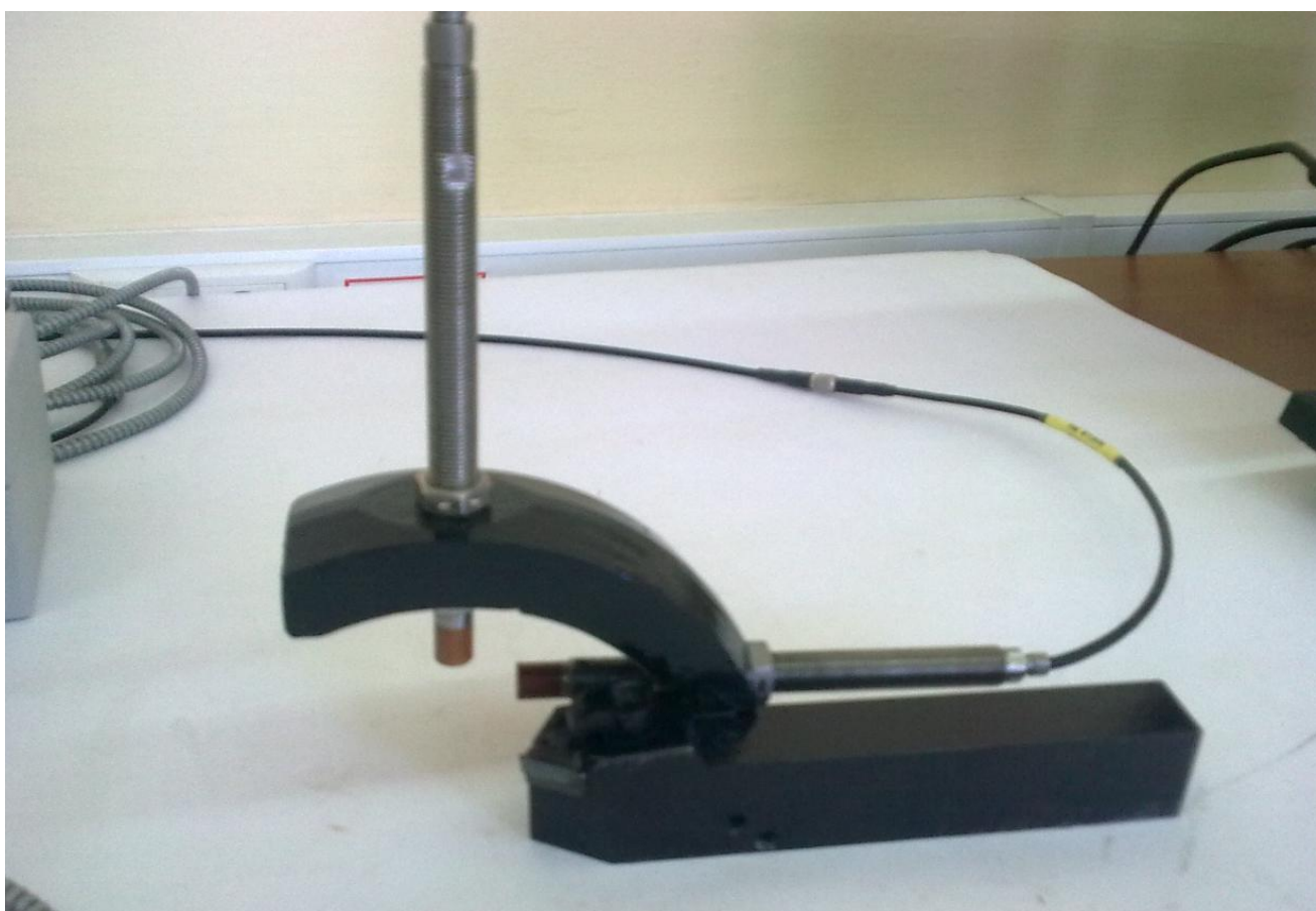
Рис. 6. Общий вид приспособления для измерения относительных виброперемещений резца и детали при точении
