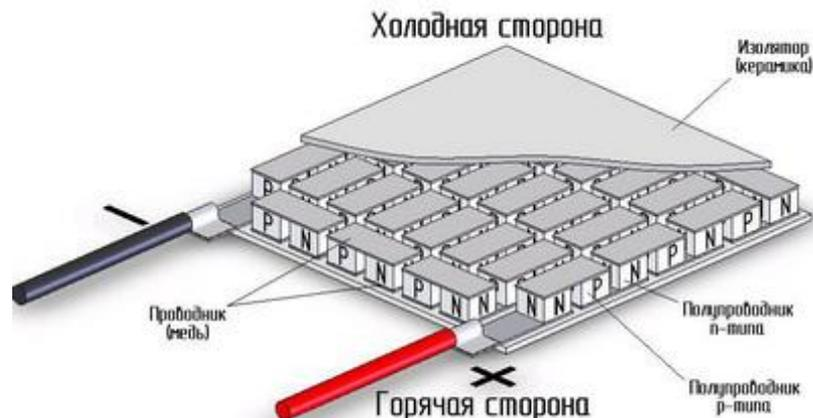
Рис. 1. Объёмный термоэлектрический модуль
