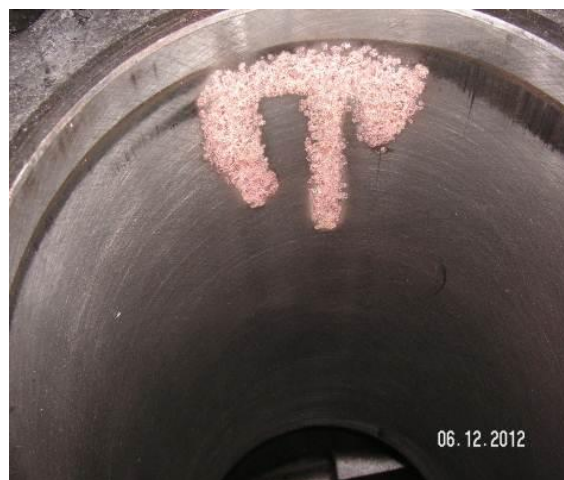
Рис. 4 – Гильза цилиндров САТ-3116 с композиционным покрытием в зоне задира от сломанного кольца
