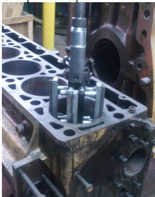
Рис. 5 – Хонингование гильз цилиндров с использованием универсальной технологической оснастки
