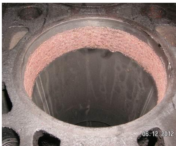
Рис. 3 – Гильза цилиндров с композиционным электроискровым покрытием зоны кольцевого износа
