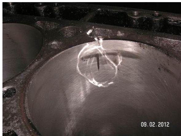
Рис. 2 - Задир гильзы цилиндра CAT-3116 после поломки поршневого кольца
