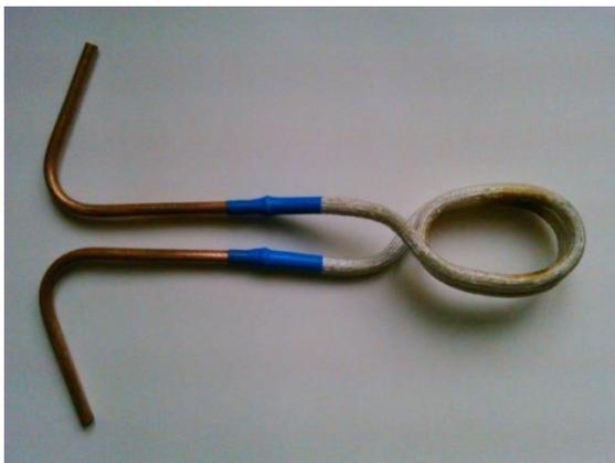
Рис.8. Индуктор для закалки после нанесения покрытия
