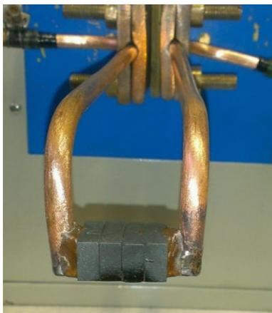
Рис. 7. Плоский односторонний индуктор для наплавки долота
