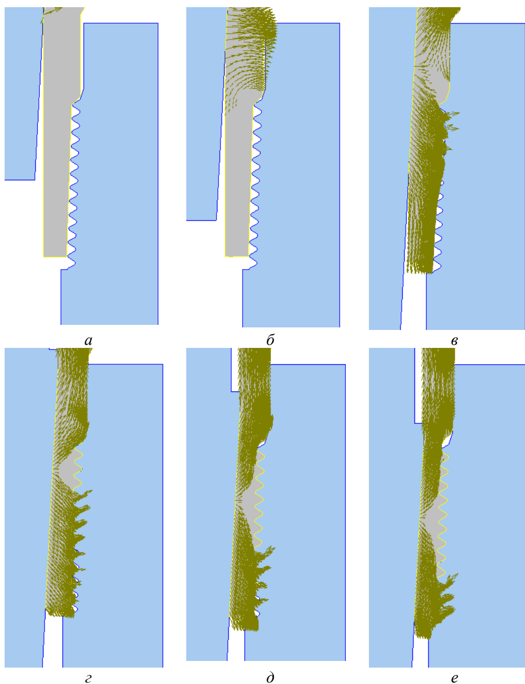
Рис.3. Стадии последовательного формообразования наружной резьбы
