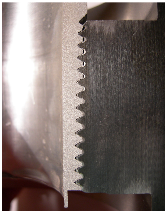
Рис.6. Ниппельный конец переводника с отштампованной наружной резьбой а – заполнение профиля резьбовой матрицы в разрезе, б – внешний вид
