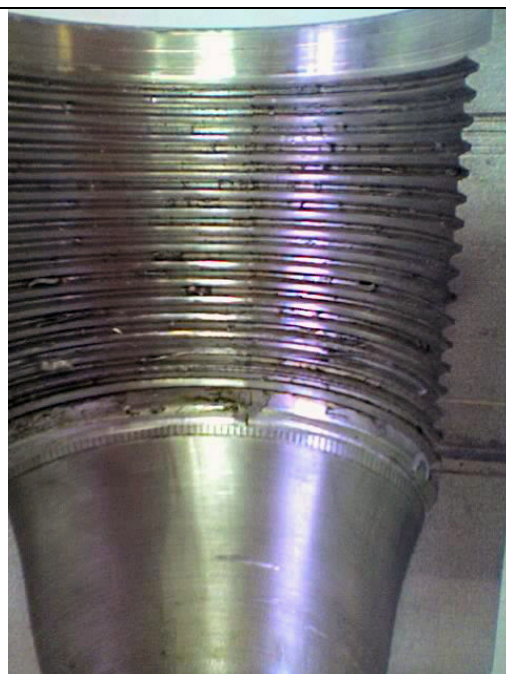
Рис.6. Ниппельный конец переводника с отштампованной наружной резьбой а – заполнение профиля резьбовой матрицы в разрезе, б – внешний вид
