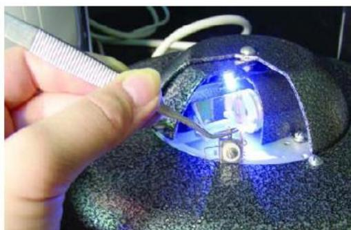
Рис. 7. Размещение образца в нанотехнологическом комплексе УМКА-02
