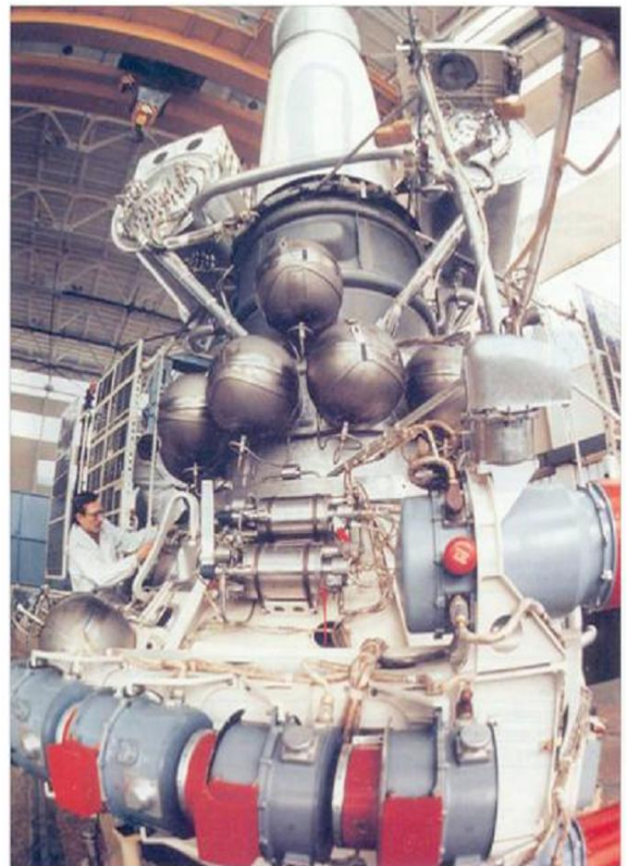
Космический корабль "Астрон". Шаровые баллоны, изготовленные из сплава ВТ23 путем сверхпластической деформации (СПД), сварки и термоупрочнения ( \sigma_B \geq 1250 МПа)
