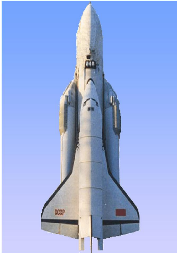
Ракетно-космический комплекс "Энергия-Буран". Общая масса деталей, изготовленных из сплава ВТ23 после ВТМО, 6т (в "Бурани") и 14т (в "Энергии"): шпангоуты, балки, лонжероны и стыковочные узлы
