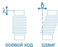
Рис.9. Деформации сильфонного узла
