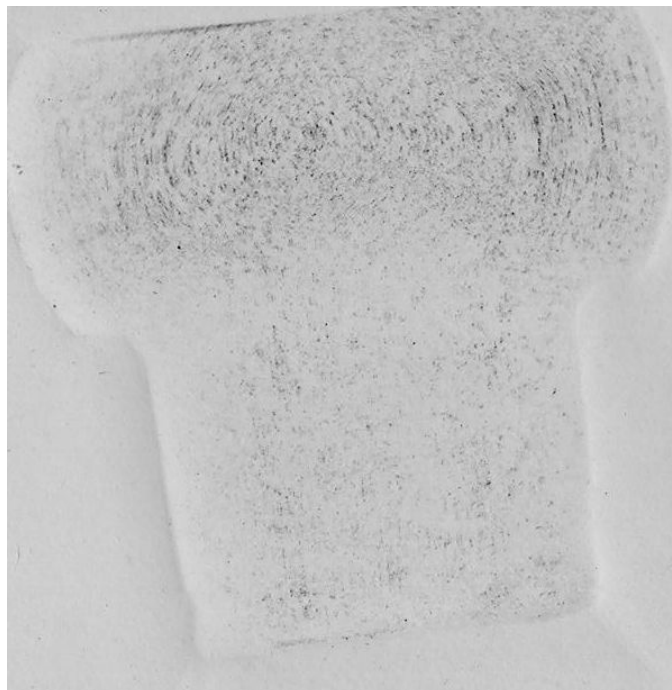
Рис. 6 Макроструктура поковки в очаге деформации
