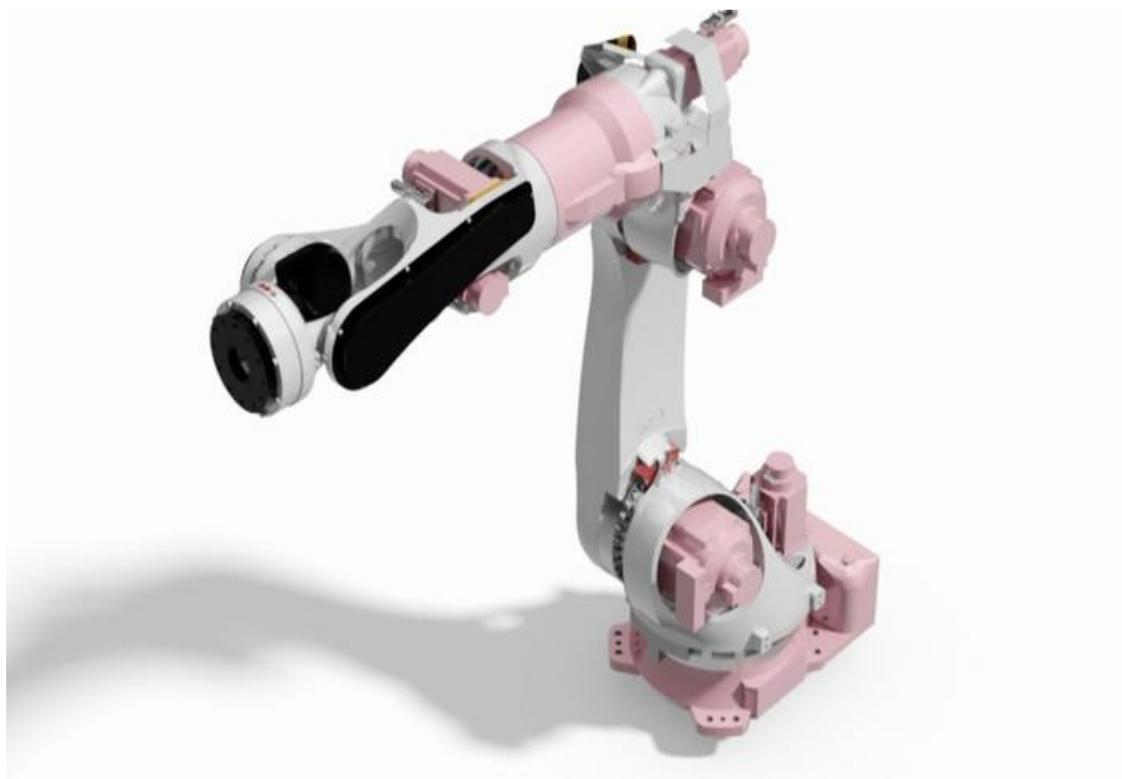
Рис. 3 Робот для точечной сварки VX200L.
