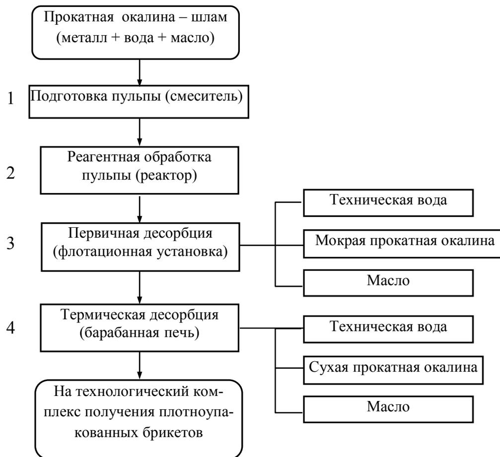
Рис. 1. Блок – схема промышленного рециклинга железосодержащих отходов на основе прокатной окалины
