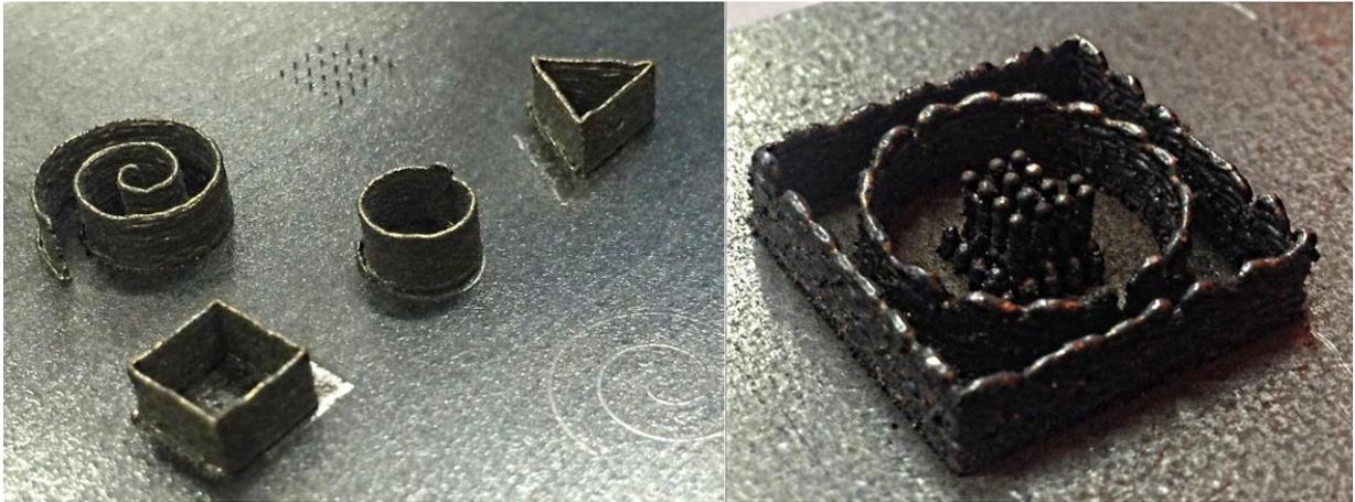
Рис. 1. Выращивание тонких стенок
