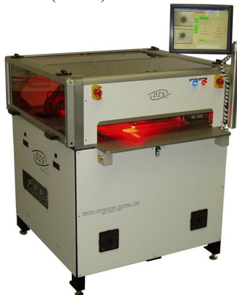
Рис. 10. Установка оптического совмещения и бондирования
