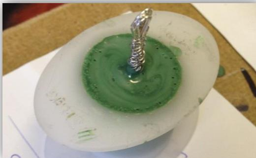
Рис. 1. Заливка шлифа
