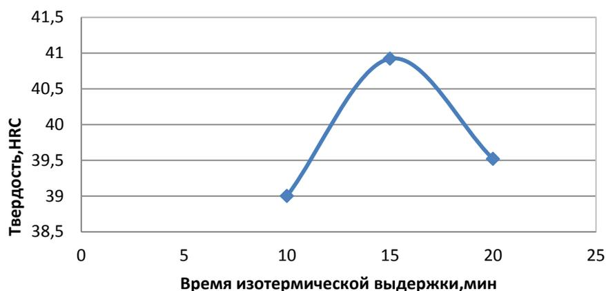
Рис.10 Твердость стали 30ХГСА с температурой изотермической выдержки 375 °С
