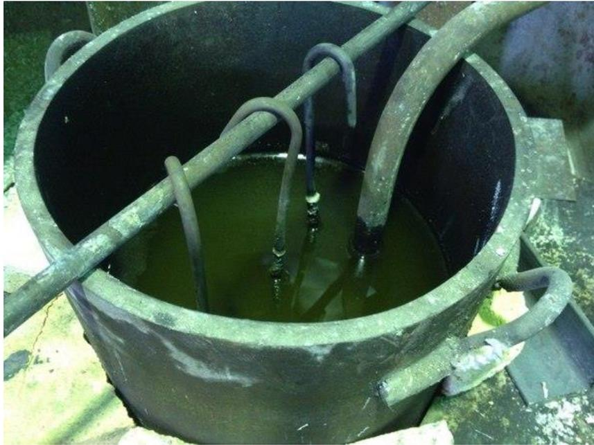
Рис.2 Печь-ванна для изотермической выдержки в расплаве селитры
