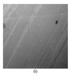
Рис. 11. Внешний вид поверхности после полировки при угле подложкодержателя в: а) 60 градусов; б) 45 градусов
