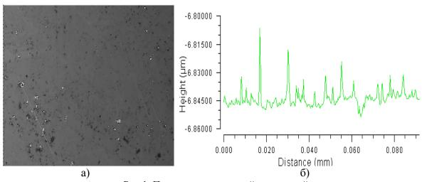
Рис 1. Поверхность исходной стеклянной пластины: а) внешний вид поверхности образца; б) профиль шероховатости поверхности подложки
