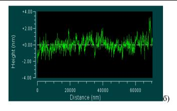
Рис. 10. Поверхность стеклянной пластины после травления с ускоряющим напряжением 2 кВ: а) Внешний вид поверхности образца; б) Профиль шероховатости поверхности подложки
