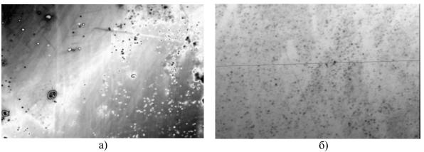
Рис. 9. Внешний вид поверхности после травления подложки в среде: а) аргона, б) аргона и кислорода
