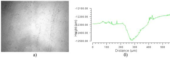
Рис. 6. Поверхность стеклянной пластины после травления в течение 30 мин: а) внешний вид поверхности образца; б) профиль шероховатости поверхности подложки
