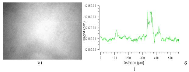
Рис. 8. Поверхность стеклянной пластины после полировки в течение 30 мин: а) Внешний вид поверхности образца; б) Профиль шероховатости поверхности подложки
