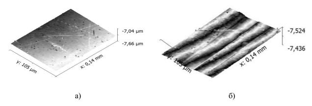
Рис 2. Внешний вид полученных поверхностей после обработки: а) изопропиловым спиртом; б) полиритом
