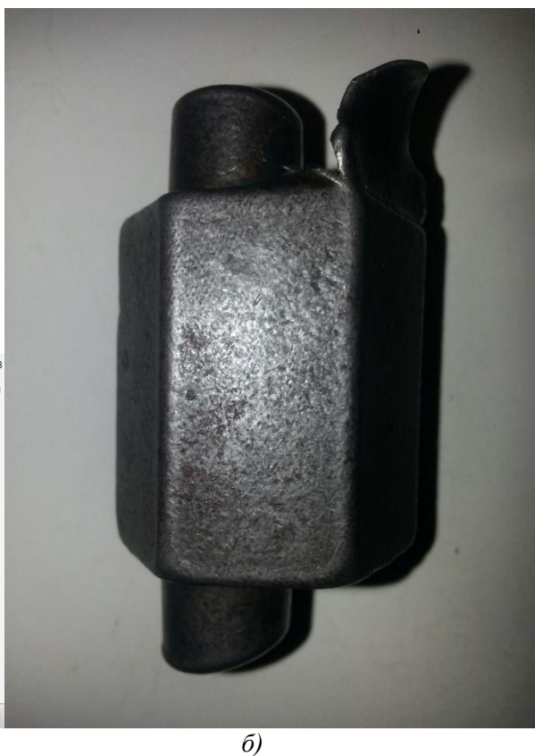
Рис.2. Дефекты поковки детали «Монорегулятора»: а – результат моделирования дефекта; б – фотография дефекта детали
