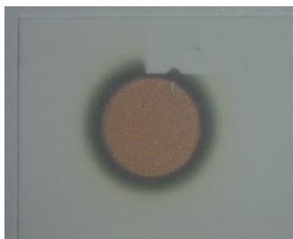
Рисунок 5 – Внешний вид полученного покрытия меди на подложке оксида алюминия
