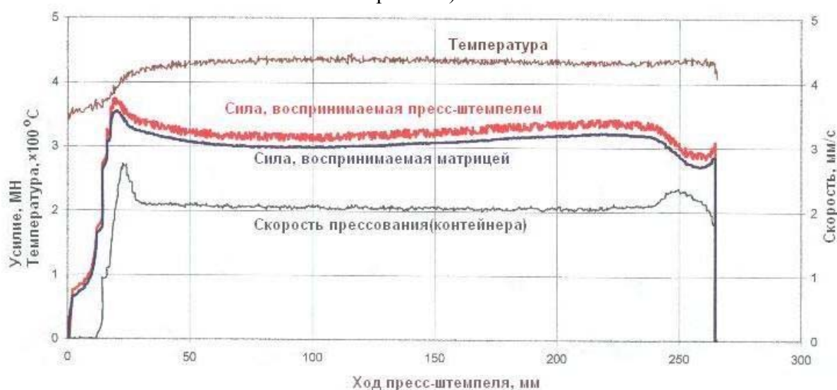
Рис. 3. График изменения усилий, температуры и скорости при обратном прессовании сплава AA2024 (эксперимент)
