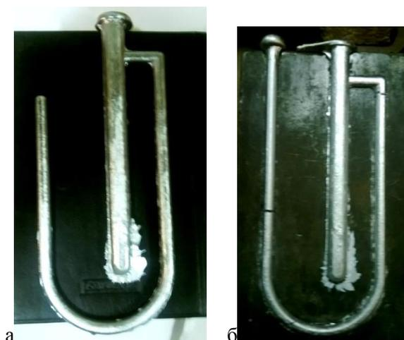
Рис.1. Отливки, полученные литьем в комплексную пробку с вертикальным U-образным каналом: а) сплав Al-9%Si, б) сплав Al-3.5%Ca-3%Mg-10%Zn.
