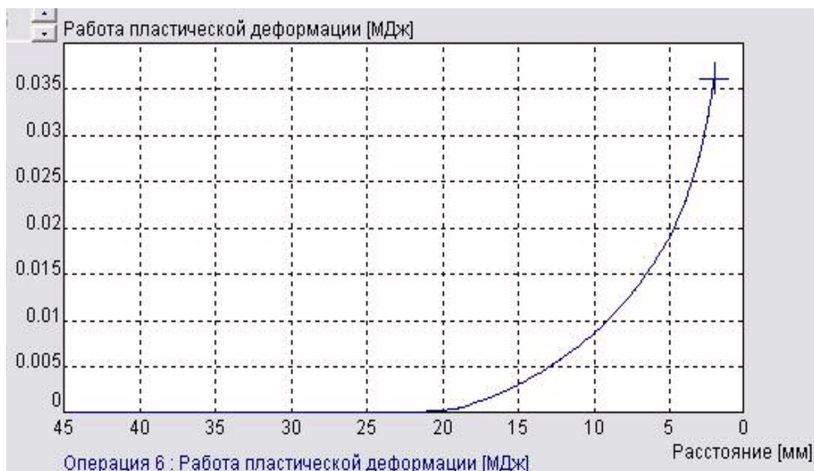
Рис.18.График зависимости работы пластической деформации от расстояния между штампами.
