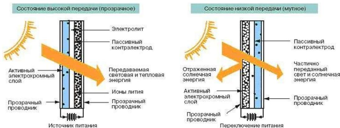
Рис 1. Принцип работы электрохромного стекла
