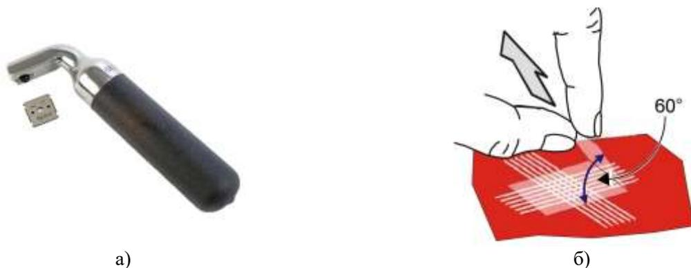
Рис. 5. Метод скрайбирования: а) скрайбер elcometer 107; б) схема отрыва клейкой ленты
