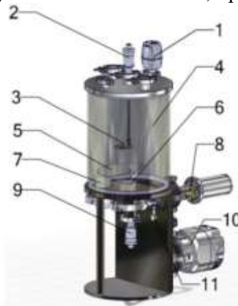
Рис. 2. Установка МВТУ-11-1: 1 – датчик вакуума широкодиапазонный; 2 – ввод вращения подложкодержателя; 3 – подложкодержатель; 4 – вакуумная камера; 5 – заслонка; 6 – магнетрон; 7 – источник ионов; 8 – электронно-лучевой испаритель; 9 – ввод вращения заслонки; 10 – турбомолекулярный насос; 11 – порт напуска газа
