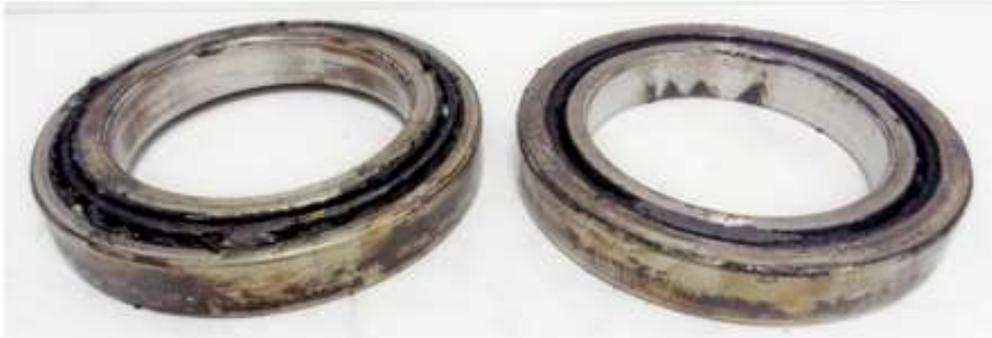
Рис. 4. Радиально-упорные подшипники передней опоры ШУ станка Mori Seiki NL3000
