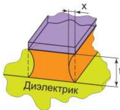
Рис. 5. Один из типов профиля проводников
