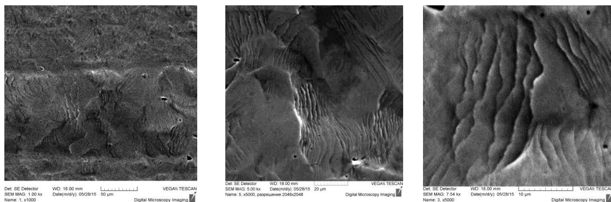
Рис. 2 Электронное изображение структуры слоев стали У8 в зоне деформации
