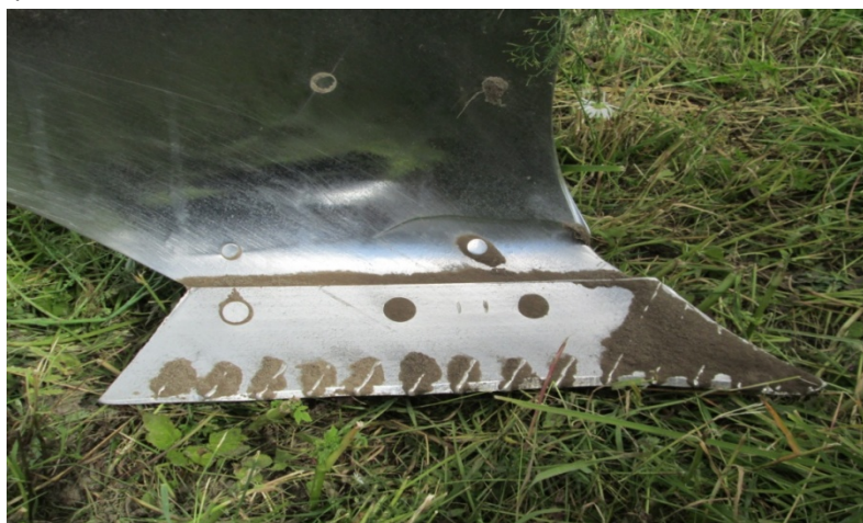
Рис.2 Формирование застойных зон контактного слоя почвы на рабочей поверхности плужного лемеха
