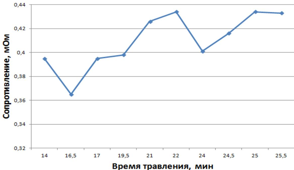
Рис. 2. График зависимости сопротивления от времени погружного травления
