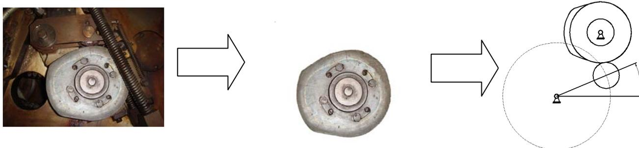
Рис.2. Последовательность определения размеров кулачка и кулачкового механизма.
