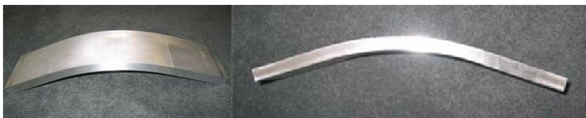
Рисунок 4 – Формообразование заготовки из Al7050 толщиной 10 мм при помощи ЛН
