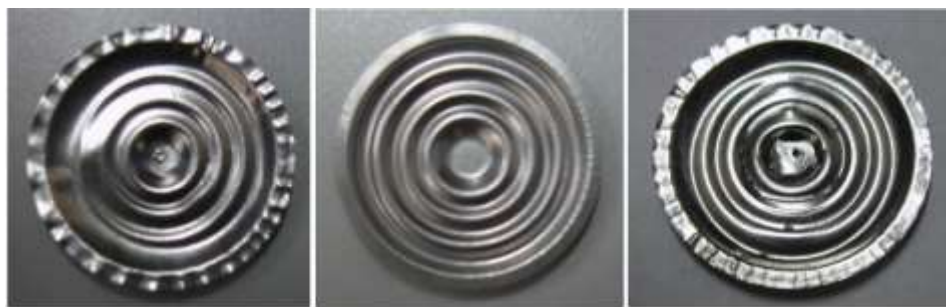
Рисунок 7 – Результаты ЛДФ с вогнутым штампом при энергиях импульса 12, 15 и 18 Дж (слева-направо)
