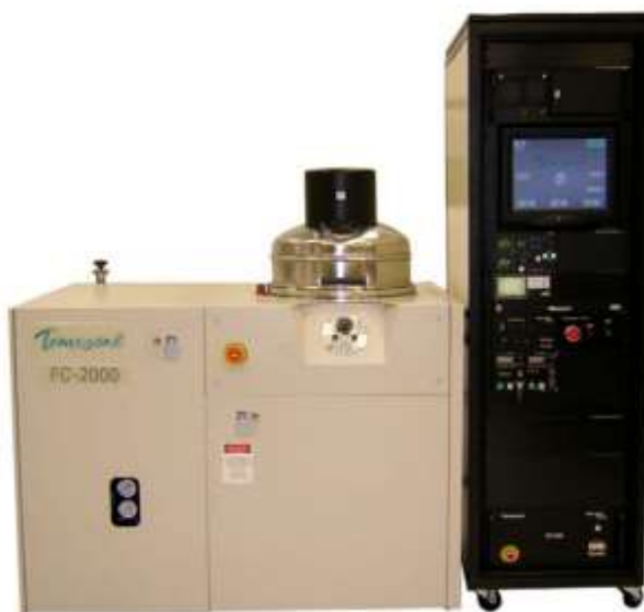
Рис. 2. Установка электронно-лучевого нанесения тонких плёнок Temescal FC2000 (2)
