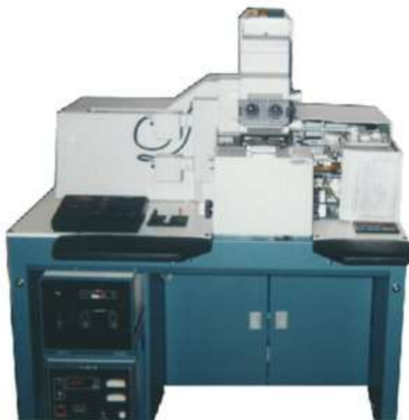
Рис. 6. Установка совмещения и экспонирования ЭМ-5026
