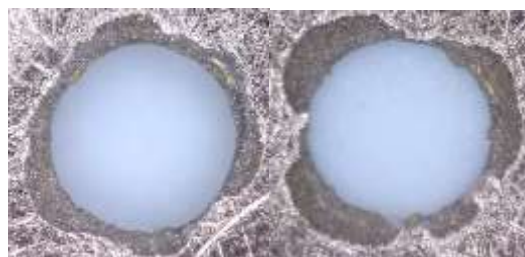
б) после удаления заусенцев шлифованием
