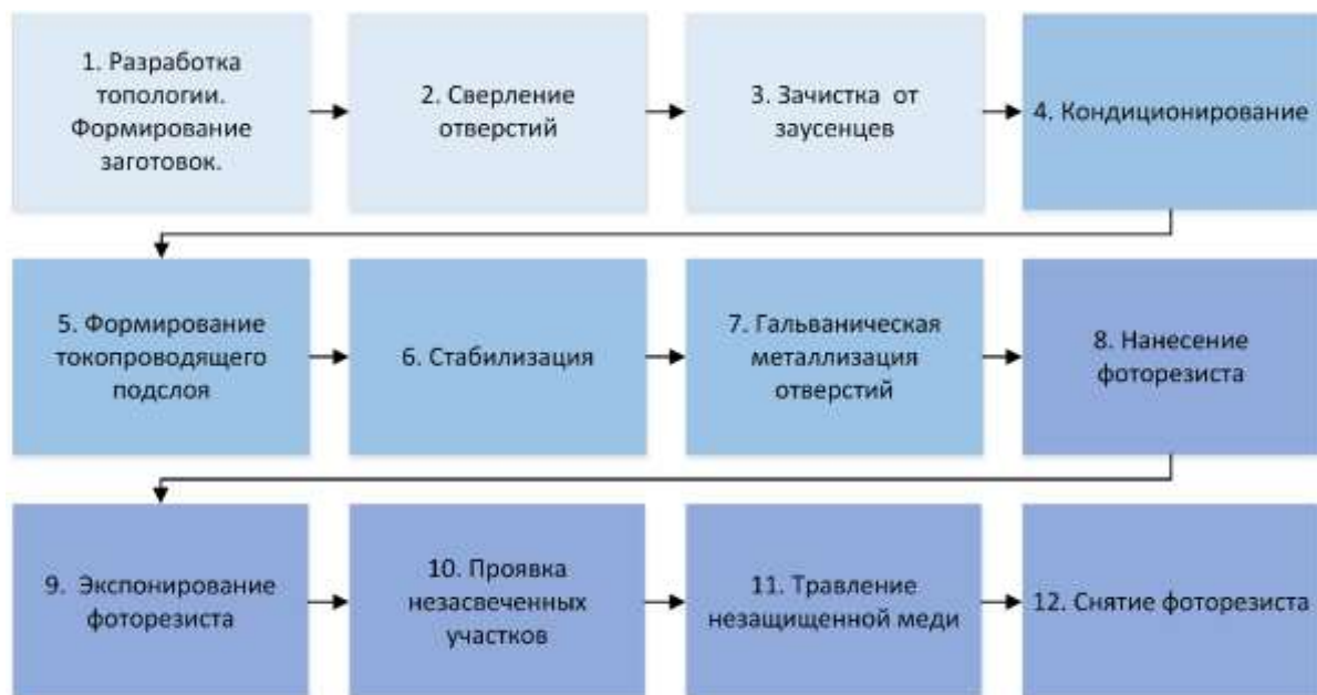
Рис. 11. Технологический процесс создания опытных образцов
