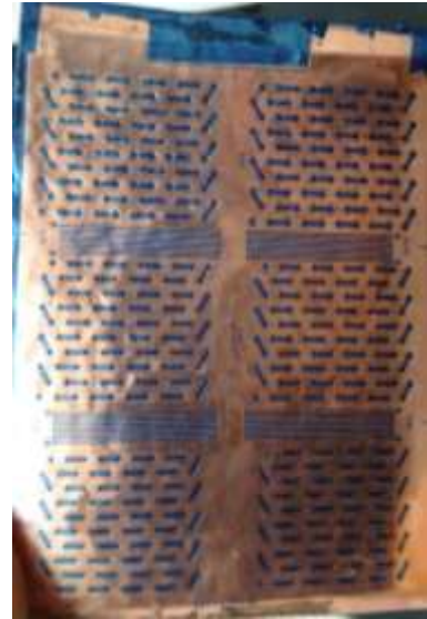
в) заготовка после процесса проявления незащищенного фоторезиста
