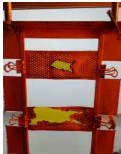
в) заготовки спустя 30 мин. пребывания в гальванической ванне
