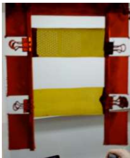
а) две заготовки перед окутанием в электролизер в рамке, обеспечивающей дополнительную жесткость и токоподвод.
