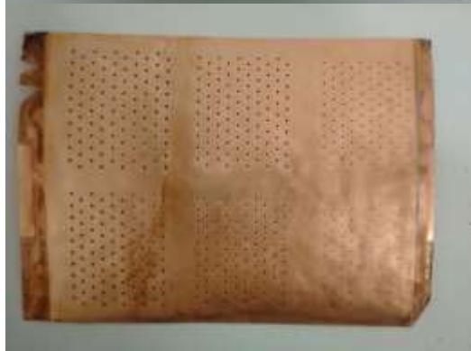
Рис. 14. Осаждение токопроводящего покрытия в отверстиях
