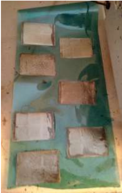
а) заготовки с нанесенным на них ламинированием фоторезистом
