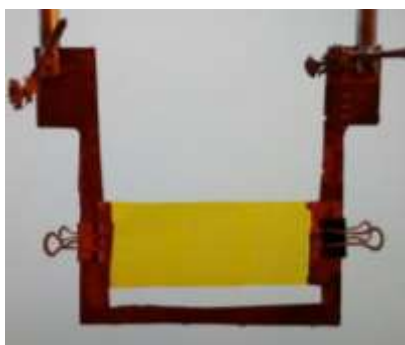
а) Заготовка перед прохождением кондиционирования в рамке, обеспечивающей ей дополнительную жесткость и препятствующую неравномерному контакту со средой
