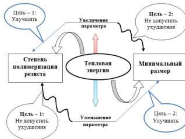
Рис. 4. Схема предметного противоречия изменения количества тепловой энергии в зоне экспонирования
