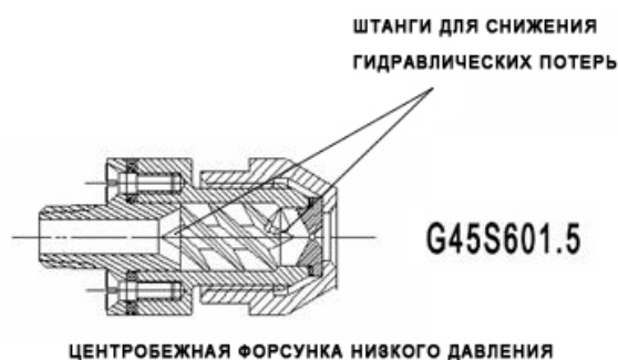
Рисунок 1. Конструкция форсунки модели G45S601.5
